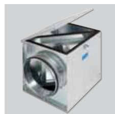
FBL-N Cajas filtrantes, suministradas sin filtro, para montar filtros AFR-N (2 como máximo). Aptas para montar en intemperie. Fabricadas en chapa de acero galvanizado. Bridas circulares con junta de estanqueidad. Tapa de abertura fácil, que permite el rápido cambio de los filtros.
